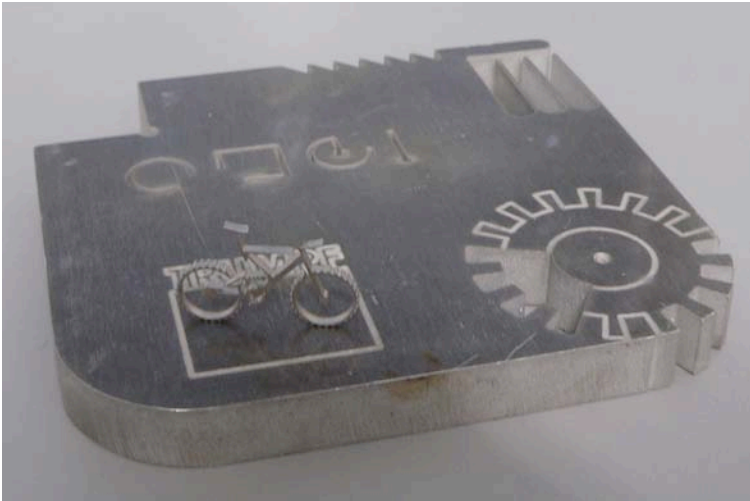
Abb. 7: Mit Lasern geschnittene Metallteile
