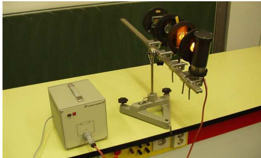
Abbildung 3.6: Versuchsaufbau zur Spektralanalyse (mit Natrium-Dampfampe)
