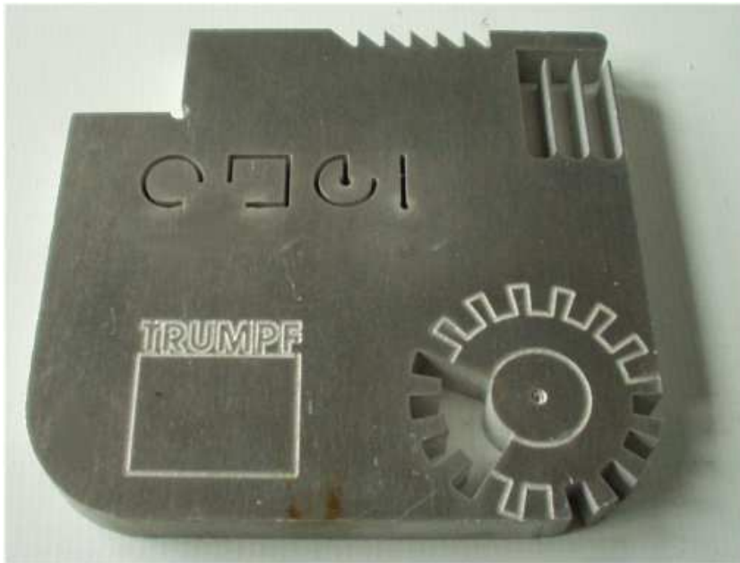
Abbildung 3.12: Ein mit einem Laser geschnittenes Metallteil
